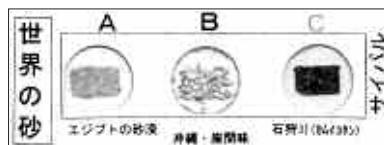
図3 砂標本観察用3穴紙プレパレート、 5×10mmの範囲に砂粒が粘着
