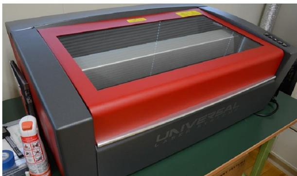
図2 レーザ加工機
