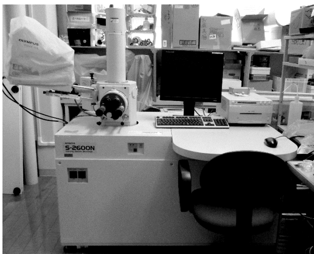
写真1 旭川市科学館の走査電子顕微鏡（日立S-2600N）
