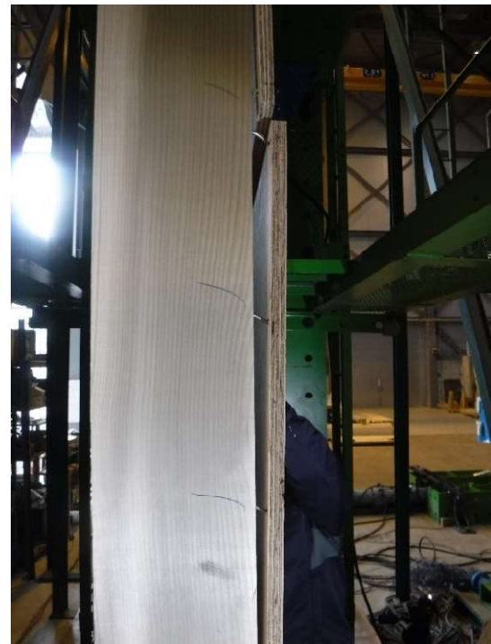
(b) 釘の引き抜け破壊
