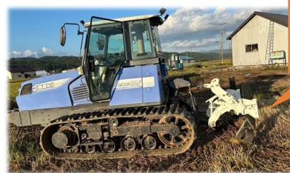
透水性・排水性向上に使用するサブソイラ
