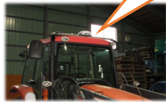
トラクターに取り付けた 自動操舵システム
