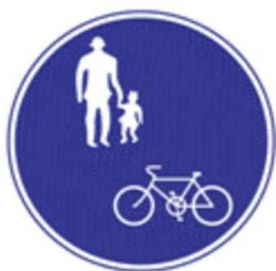
普通自転車歩道通行可の標識
