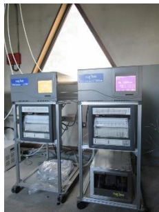
図5-3 大気汚染測定装置
