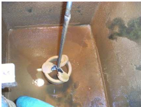
攪拌装置のスケーリング
