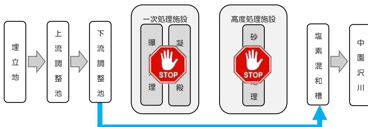
図2 一次・高度処理施設停止時のフロー
