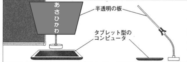
先生：光の反射を利用したテレプロンプターは、話し手からは文字が見えますが、聞き手からは見えません。タブレット型コンピュータと半透明な板を使ってテレプロンプターの仕組みを学習していきましょう。
