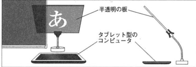
先生：光の反射を利用したテレプロンプターは、話し手からは文字が見えますが、聞き手からは見えません。タブレット型コンピュータと半透明な板を使ってテレプロンプターの仕組みを学習していきましょう。
