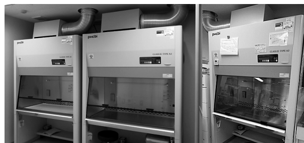
写真4 検体の取り扱いに必須な安全キャビネット (左：クリーンルーム内の2台、右：細菌検査室の1台)
