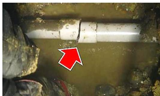
『破断した塩化ビニル管 (TS接続型継手)』
