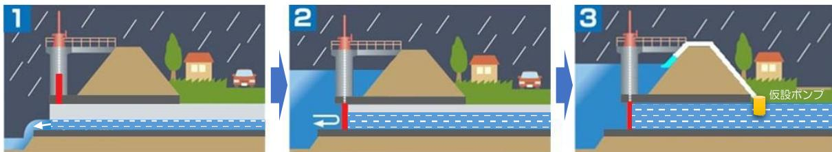
通常、街に降った雨は雨水管を通じて河川に流れていきますが、大雨などで河川の水位が上がってくると、川の水が街に逆流してしまうため、**樋門**を閉めます。
