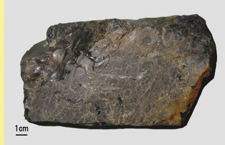
写真6 一見良質の黒曜石に見えるが、表面には同心円状～渦巻状の割れ目が存在し、不規則に割れる。上藻別Aの露頭で採取。
