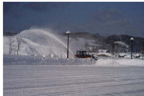
場内除雪作業
