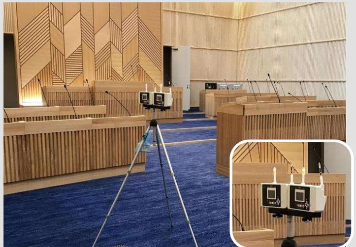
VOC測定は、部屋を30分間換気したあと5時間密閉し、その後30分間かけて採取した空気を分析するよう採取方法が決められています。
