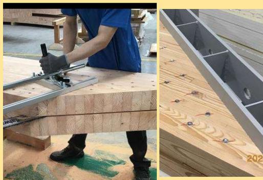
建物本体の鉄骨梁とボルトで接合するため、木質梁の端部に鉄骨の接続部材を取り付けます。梁に切り込みを入れ接続部材を差し込み金属棒を貫通させ一体化させます。（建物への取付はNEWS Vol. 14に掲載）
