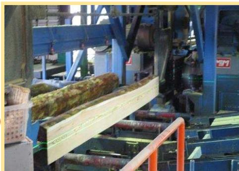
工場では、所定の大きさに切り分けます。年輪の入り方により強度や変形のしやすさなどが変わるため、丸太の特性を見極め、無駄を最小限にしつつ切り方を決めるのも重要な技術です。
