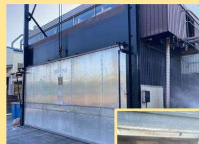
製材した木材は、用途に合わせ最適な含水率になるまで乾燥させます。急激な乾燥はひび割れにつながるため、6か月間屋外で乾燥させた後、人工乾燥機に入れて所定の含水率にします。
