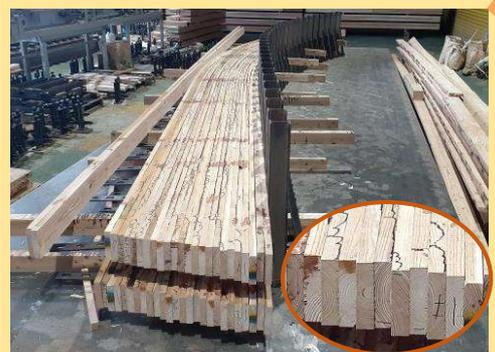
議場の梁は、厚さ3cmほどの製材を貼り合わせて作る断面が24×66cmの大断面集成材で、大空間の屋根の重さや地震の力にも耐える高強度の木質梁です。湾曲させるために型となる治具を使って成形しながら接着剤で圧着します。
