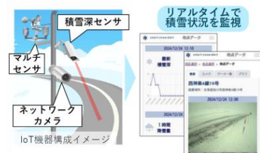
▲積雪状況監視・ 通報システム
