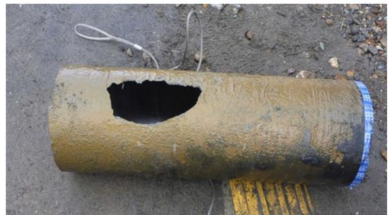
口径30センチメートルの配水管に、約30センチメートルの穴が空き、漏水しました。1分間に16トンの水が噴き出し、道路が冠水しました。
