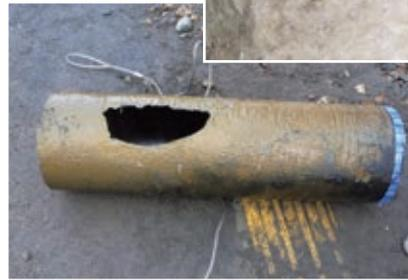
劣化により破損した水道管
