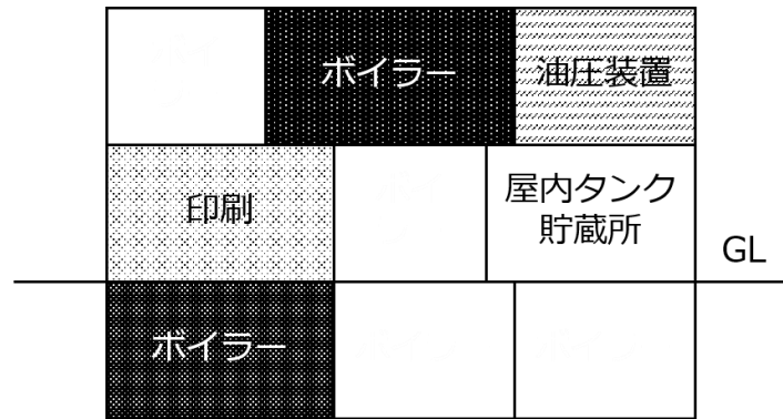
〔部分規制（設備単位）の複数設置例〕
