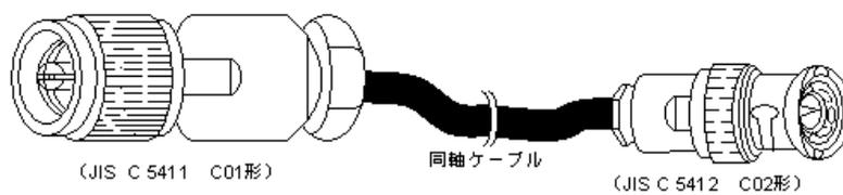
第 23-3 図 接続用の同軸ケーブル外観図
