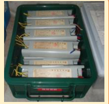
安定器の保管の例(左:倉庫での保管例、中央:ドラム缶収納、右写真:プラスチックケース収納)
