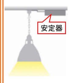
天井への設置例
