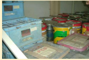
安定器の保管の例(左:倉庫での保管例、中央:ドラム缶収納、右写真:プラスチックケース収納)
