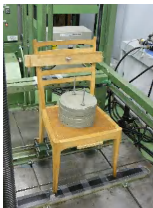
繰返し衝撃荷重試験 (mマーク)
