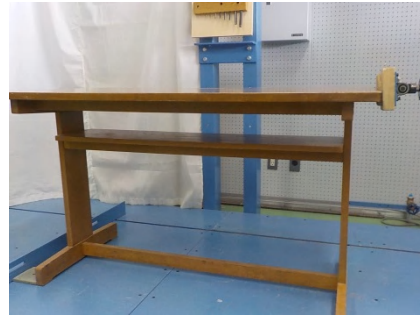
水平力試験 (JIS S 1205 7.2)
