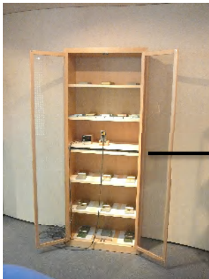
棚板のたわみ試験 (JIS S 1200 6.1.3)
