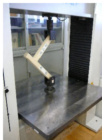
接合部の強度試験 (自主規格)
