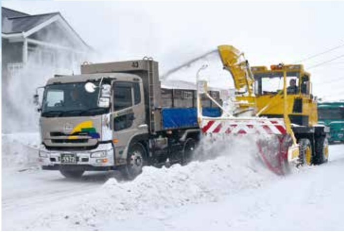
旭川市内の道路で排雪を行う作業車両
