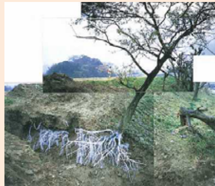
堤防法面に生育したアカメヤナギの根を調べた例
