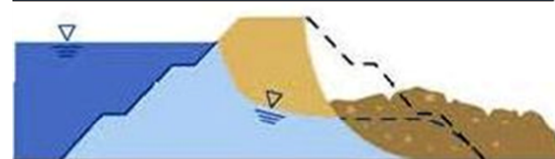
堤防内の水位が更に上がり、堤防が弱くなって崩壊しやすくなる
