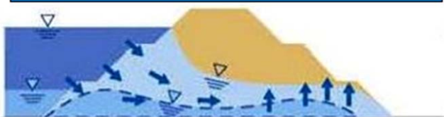
堤防内の水位が更に上がり、堤防が弱くなって崩壊しやすくなる
