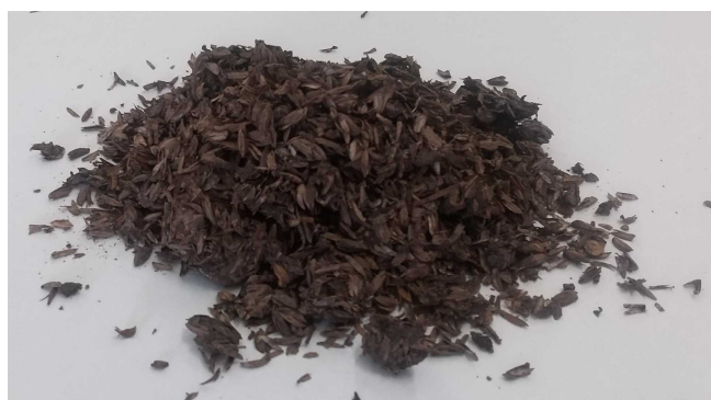
下水汚泥肥料(試作品:左図)と、下水汚泥肥料を施用した土壌による栽培試験の様子(右図)
