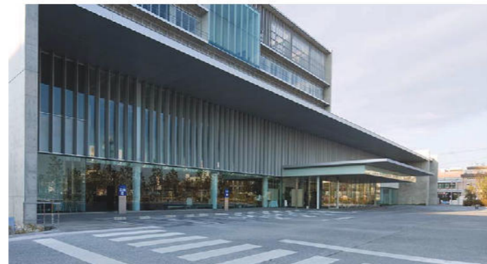
底のある出入口横の身障者用駐車場と車寄せの事例（西海市庁舎）
