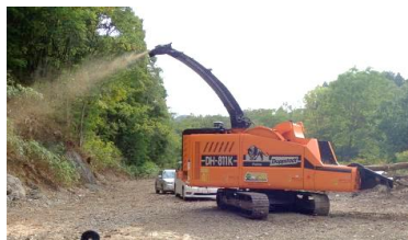
◀ 移動式チップパーによる チップ破碎作業
