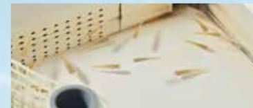
安全な水をつくるために、生き物が活躍しています。浄水場へ川から水を取り入れる際、川の水の中でヒメダカとコジマス泳がせ、毒物がないかどうかをチェック。その様子は常時カメラで監視しています。
