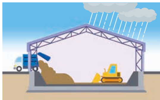
覆蓋型施設の断面図。埋立地は屋根で覆われている
